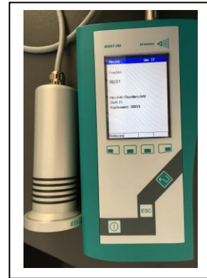
Feuchtigkeitsmessung mit Mikrowellenmesstechnik Quelle: Robert Kussauer
